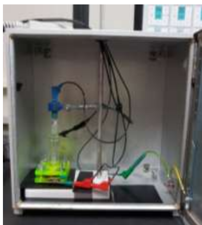
Figura 1 – Célula eletroquímica montada dentro da gaiola de Faraday com eletrodos devidamente posicionados.
