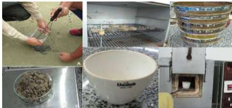
Figura 2. Coleta (A); estufa (B); peneiras (C); amostras pesadas (D); cadinho (E); mufla (F).
