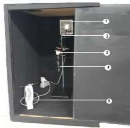
Figura 1. Caixa de madeira com equipamentos auxiliares ao processo de fotólise. 1) exaustão do ar interno; 2) estante para suporte da lâmpada; 3) Soquete para fixação da lâmpada; 4) Lâmpada de vapor de mercúrio de 125 W; 5) Ventilador. Fonte: Pestana, 2018 [1].
