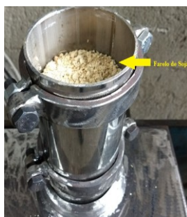
Figura 3- Célula de compressão com o farelo de soja NGMO
