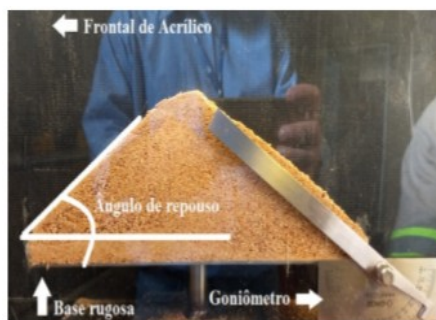
Figura 1- Esquemático de Aparato 1
