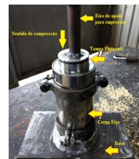
Figura 5- Detalhe da célula de compressão
