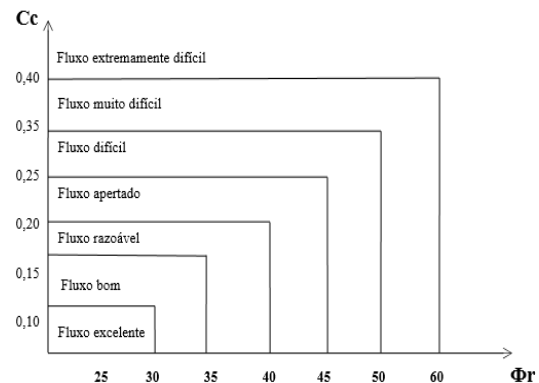
Figura 7- Condições de fluxo consolidado
