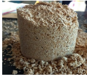
Figura 8- Estado do farelo compactado
