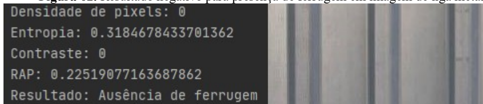
Figura 02. Resultado negativo para presença de ferrugem em imagem de liga metálica.
