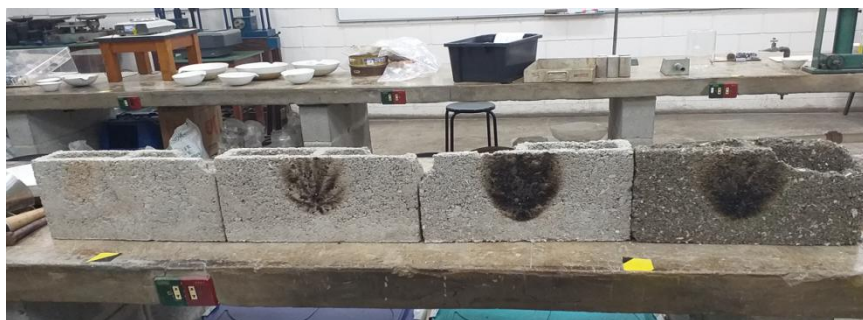
Figura 2: Blocos dispostos na sequência: sem plástico, 5%, 10%, substituição de pedrisco por plástico. Fonte: Elaborado pelo Autor (2021).
